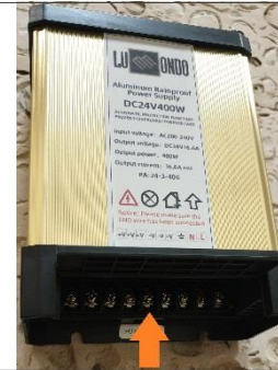
Рис. 4. Выход клеммной колодки
